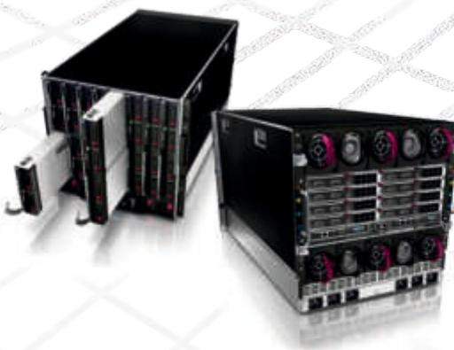
Конструктив ССВП предназначен для установки серверов специального исполнения, называемых «лезвием» (от английского «blade»). На уровне системного и прикладного ПО «лезвие» не отличается от типового сервера, установленного в стандартную монтажную стойку.
